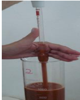
Figura 3. Análisis de tamaño de partícula con una pipeta.
