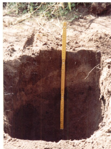
Figura 03: Trincheiras para coleta de amostra na área de planejamento do uso do solo, com 20 cm de profundidade e com 40 cm. (10/10/2004).
