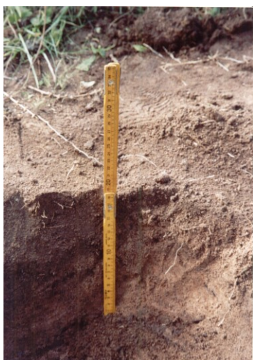
Figura 03: Trincheiras para coleta de amostra na área de planejamento do uso do solo, com 20 cm de profundidade e com 40 cm. (10/10/2004).
