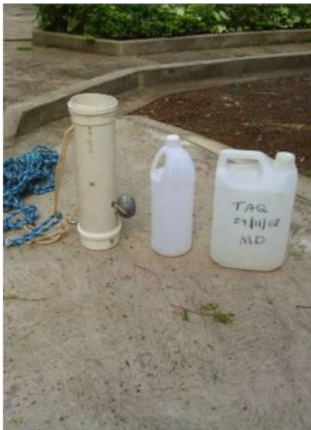
Figura 3: Coleta de água para análise de sedimento suspenso no rio Ivaí, ponte de Porto Ubá com coletor pontual de garrafa
