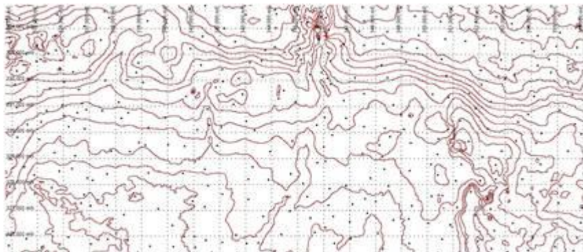
Fig.13. Diferencias entre los resultados de interpolación por Mínima Curvatura y los datos originales.
