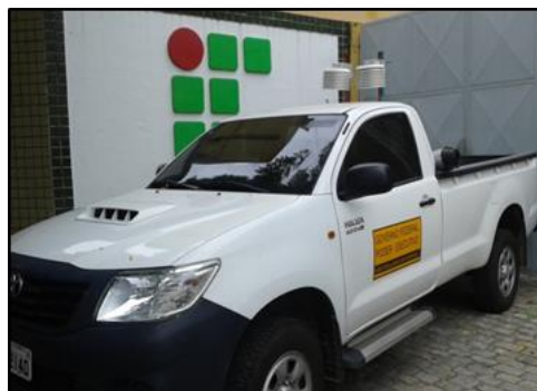
Figura 04 – Sensores presos a pick-up para a realização do Transecto Móvel Fonte: Autor (2016).
