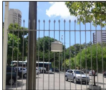
Figura 08 – Sensor tipo HOBO instalado no Ponto 03 (Igreja Fátima).
