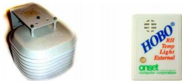
Figura 03 – Protetor tipo shield (à esquerda) e sensor HOBO (à direita). Fonte: Lopes (2012).
