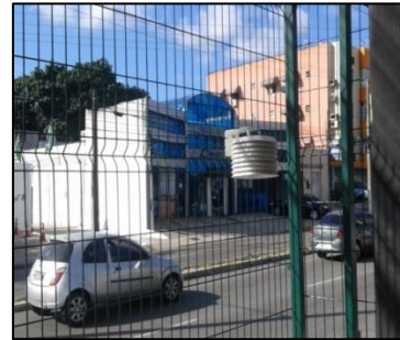
Figura 09 – Sensor tipo HOBO instalado no Ponto 04 (Concessionária). Fonte: Autor (2016).
