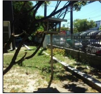
Figura 07 – Sensor HOBO instalado no Ponto 02 (IFCE - Fortaleza). Fonte: Autor (2016).
