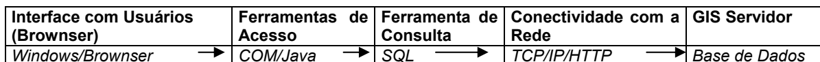
Figura 1 – Procedimento padrão para o acesso remoto de múltiplos usuários a uma base de dados geográficos via WWW (adaptado de ArcNews, 2000, p. 7).
